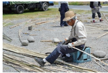
用途に合わせて太さを変えて竹を割ります。
