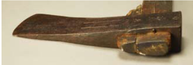
【キリヨキ】木の繊維を切断できるよう、刃は薄く鋭い。 W41 H251 D(刃幅)80 柄長 912
