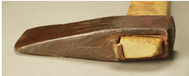
【ワリヨキ】刃は分厚くて重たく、くさびに近い形状。 W39 H207 D(刃幅)65 柄長 915
